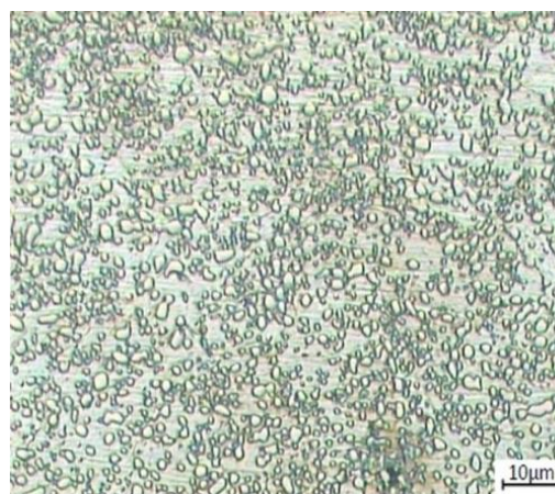
شکل ۱۴. ریزساختار اولیه فولاد، زمینه فريت با توزيع کاربرد
