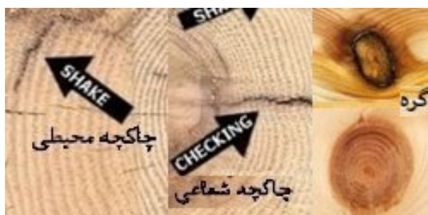
شکل ۱۰. عیوب چاک شعاعی و محیطی در چوب.
