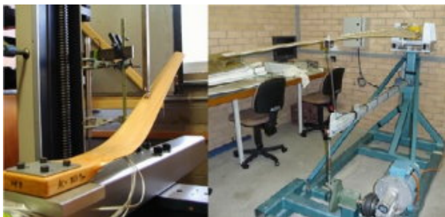
شکل ۸. آزمون ایستایی (چپ) و خستگی (راست) پره توربین [۱۱]
