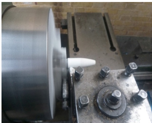
شکل ۴. تصویر نمونه پیش‌تفجوشی بسته‌شده به دستگاه تراش
