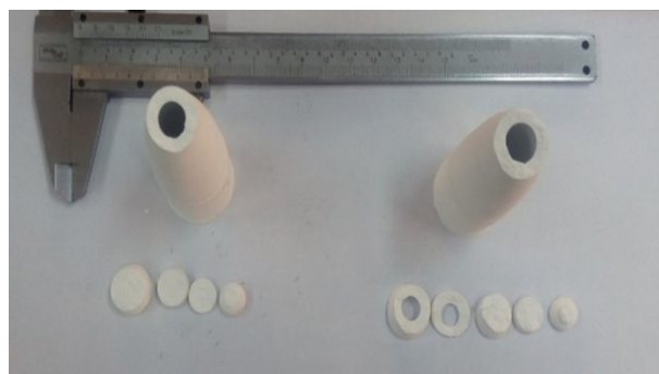
شکل ۶. تصویر نمونه‌های پرس‌شده ترکیب ۲ و ۳
