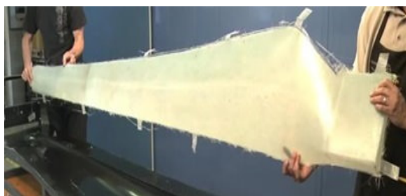
شکل ۱۶. نمونه نیم‌پره کامپوزیت خارج‌شده از قالب [۲۵]
