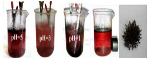
شکل ۲. رنگ محلول در دقایق نهایی آزمایش برای محیطهای اسیدی و نحوه‌ی جداسازی با استفاده از آهنربا.
