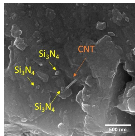
شکل ۱۳. توزیع مناسب فاز ثانویه در زمینه آلومینیوم نمونه حاوی ۱۵ درصد وزنی نیتريد سيليسيم حاوی پنج درصد وزنی نانولوله کربنی سیتتر شده به روش پلاسمای جرقه‌ای.
