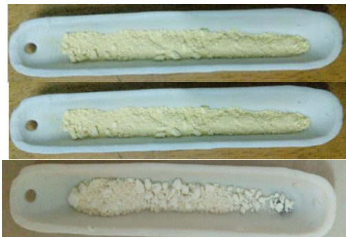
شکل ۱. الف) کربن نیتريد گرافیتی و ب) نانورقه تولید شده به روش حرارتی.
