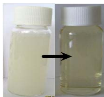
شکل ۲. نانوامولسیون سنتز شده حاوی ۵٪ اسانس زیره قبل (چپ) و بعد (راست) از فرآیند سونیکاسیون.
