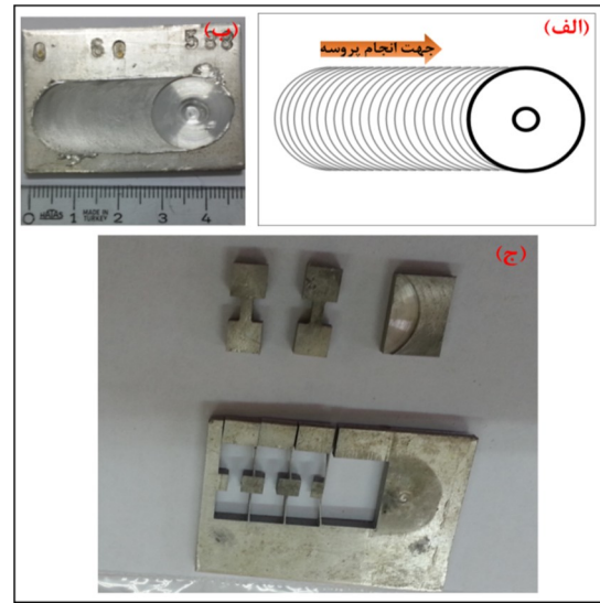
شکل ۲. الف) شماتیک فرایند اصطکاکی اغتشاشی، ب) نمونه آلومینیوم خالص فراوری شده و ج) نمونه آزمون کششی تهیه شده از آن.
