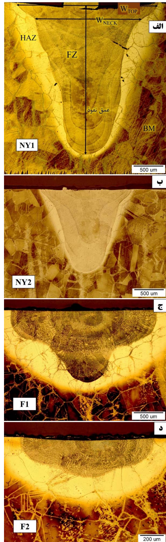
شکل ۲. درشت ساختار مقاطع عرضی جوش لیزر پالسی
