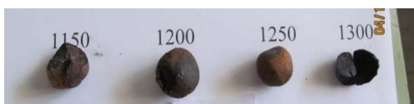
شکل ۹. تصاویر گندله تهیه شده از نمونه حاوی کربن بعد از دماهای مختلف.
