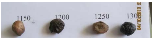
شکل ۸. تصاویر گندله تهیه شده از نمونه بعد از دماهای مختلف.
