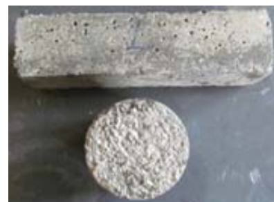
شکل ۱۰. نمونه‌های مورد آزمایش استحکام فشاری (استوانه‌ای) و خمشی (مکعب مستطیل)
