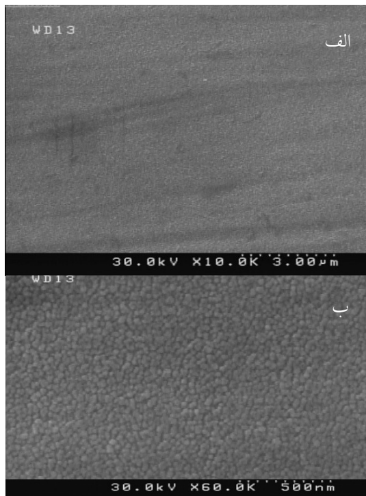
شکل ۶. تصاویر FE-SEM مربوط به نمونه شماره (۴) پوشش \text{TiO}_2 ، ۷ درصدوزنی \text{WO}_3 در دمای ۴۰۰ درجه سانتی‌گراد، (الف) پوشش با بزرگنمایی ۱۰۰۰۰ برابر، (ب) پوشش با بزرگنمایی ۶۰۰۰۰ برابر.
