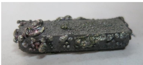
شکل ۵. تصویر تجمع قطرات مذاب منجمد شده آلومینیوم در سطح نمونه
