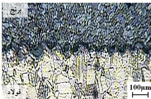
شکل ۲. فصل مشترک های بالا و پایین حاصل از جوش انفجاری در قسمت بالای ساندویچ سه لایه در بزرگنمایی 200\times (شماره تصاویر معرف شماره نمونه ها، هستند).
