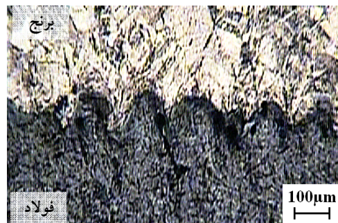
شکل ۲. فصل مشترک های بالا و پایین حاصل از جوش انفجاری در قسمت بالای ساندویچ سه لایه در بزرگنمایی 200\times (شماره تصاویر معرف شماره نمونه ها، هستند).
