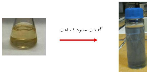
شکل ۳. تصویر نوری که نشان دهنده روند مشخص تغییر رنگ محلول کلئوئیدی نانوذرات نقره کروی شکل (زرد رنگ) و محلول نانوذرات مثلثی شکل نقره (آبی رنگ) حاصل در دمای اتاق است.
