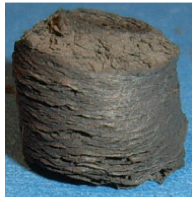
شکل ۶. شکل ظاهری محصول سنتز شده در راکتور (در محیط گاز آرگون با فشار نسبی ۱/۵ بار مثبت، ابعاد تقریبی: D:12mm, h:10mm)
