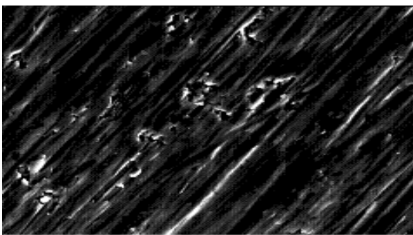
شکل ۶. تصویر میکروسکوپ الکترونی سطح تیتانیم آندایز شده در محلول اسید سولفوریک به مدت ۹۰ دقیقه.
