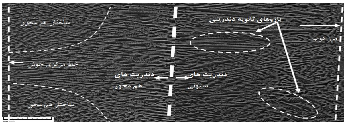
شکل ۳. ساختار فلز جوش لیزر در آلیاژ مس برلیوم برای نمونه ۲.
