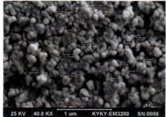
شکل ۴. تصویر SEM نانوفریت روی با آلایش ۱۰ درصد وزنی نقره
