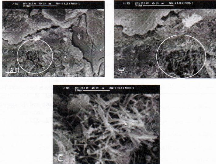
شکل ۱۵. تصویر میکروسکوپ الکترونی روبشی (SEM) الف و ب و ج: مکانهای متخلخل در فاز سیمانی (نمونه F)
