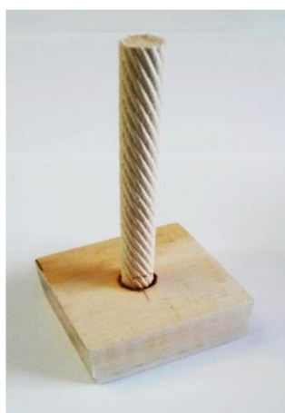
شکل ۱. نمونه‌ی آزمونی توان نگهداری دابل چوبی (راست: شماتیک و دابل صاف؛ چپ: اتصال جوشکاری‌شده با دابل شیاردار)
