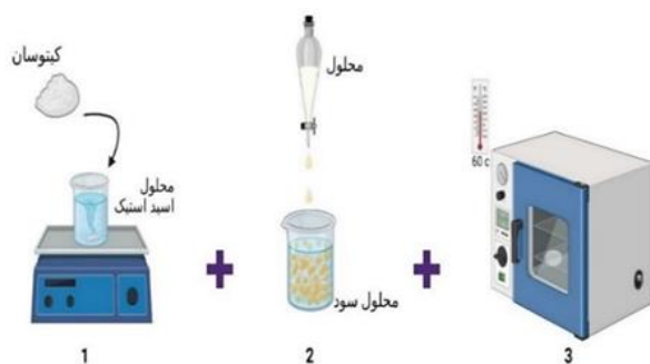
شکل ۱. مراحل تهیه کامپوزیت کیتوسان
