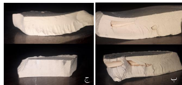
شکل ۸. الف) تأثیر زمان تزریق بر پر کردن قالب در فشار ۴ بار و دمای ۹۰ درجه سلسیوس، ب) وجود حفرات در داخل قطعه (زمان نگهداری: ۵ ثانیه) ج) قطعه بدون حفره (زمان نگهداری: ۱۰ ثانیه)
