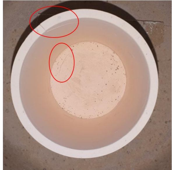
شکل ۶. ترک‌های به وجود آمده در حین فرایند چسب‌زدایی
