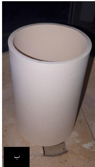
شکل ۱۲. بوت‌ه (الف) تزریق‌شده، (ب) چسب‌زدایی‌شده و (ج) زینترشده
