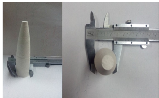
شکل ۵. تصویر نمونه‌های پرس‌شده ترکیب ۱، ۴، ۵ و ۶
