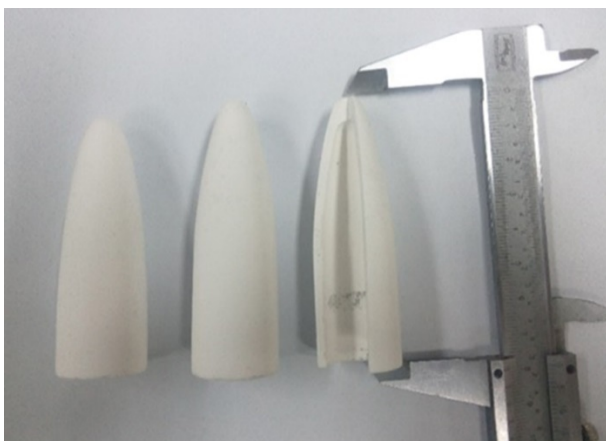
شکل ۸. تصویر نمونه‌ها ترکیب ۴ و ۵ پس از ماشین‌کاری
