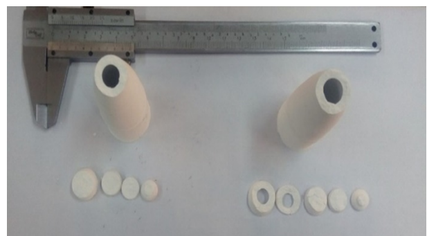
شکل ۶. تصویر نمونه‌های پرس‌شده ترکیب ۲ و ۳
