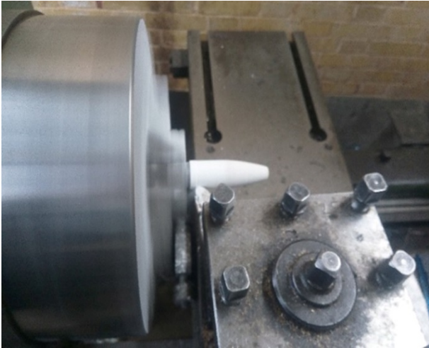
شکل ۴. تصویر نمونه پیش‌تف‌جوشی بسته‌شده به دستگاه تراش
