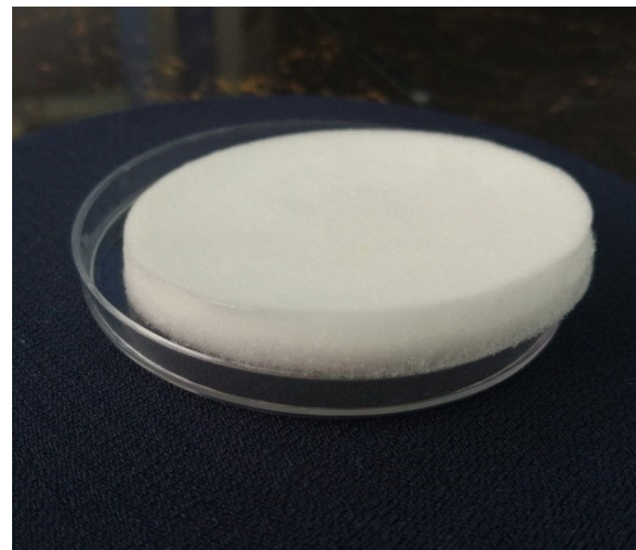
شکل ۵. داربست تهیه شده توسط خشک‌کردن انجمادی
