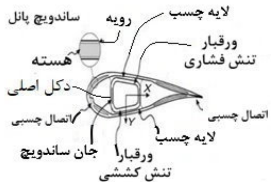
شکل ۱۳. ساختار جزئیات پره با دکل و پوسته خارجی [۲۴]
