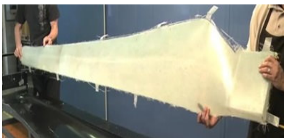
شکل ۱۶. نمونه نیم‌پره کامپوزیت خارج‌شده از قالب [۲۵]
