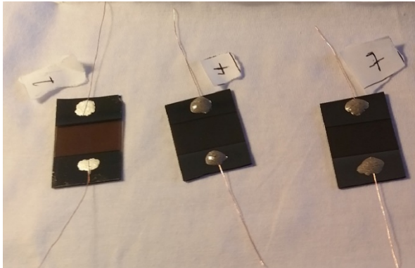
شکل ۱. تصویر نمونه‌های \text{TeO}_2 لایه‌نشانی شده روی زیرلایه‌های شیشه‌ای با ضخامت‌های مختلف و اتصال الکتریکی انجام شده
