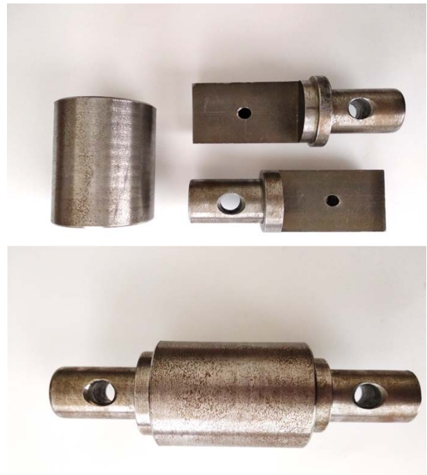
شکل ۳. تصویر نگهدارنده نمونه‌های کشش جهت انجام آزمون کشش برشی
