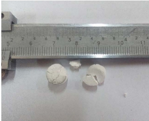
شکل ۳. تصویر نمونه M10 پس از تف‌جوشی در دمای ۱۴۰۰ درجه سلسیوس
