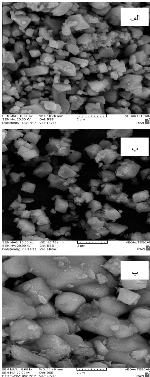
شکل ۳. تصاویر میکروسکوپ الکترونی روبشی نمونه های سنتز شده در دمای (الف) ۸۰۰ (ب) ۸۵۰ (پ) ۹۰۰ درجه سانتی گراد.
