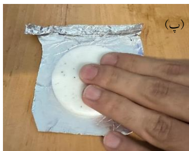
شکل ۶. (الف) تصویر شماتیک اجزای نانوذراتور تریبوالکتریک شامل پوست دست، سیلیکون بهداشتی و الکتروود آلومینیم و تصویر، (ب) شماتیک و (پ) واقعی نانوذراتور تریبوالکتریک مونتاژشده در حالت کاری تک‌الکتروودی
