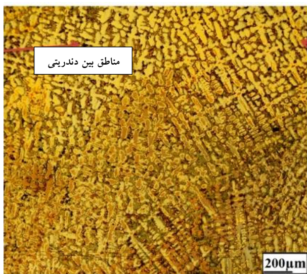
شکل ۲. تصویر ریزساختار میکروسکوپ نوری شمش آلیاژ
