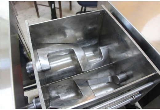
شکل ۴. همزن Z-blade برای ترکیب مخلوط چسب و پودر زیرکونیا
