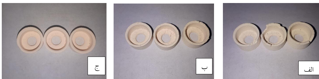
شکل ۱۰. تصویر نمونه‌های زیرکونیایی پس از چسب‌زدایی با نسبت جامد الف) ۵۲ درصد، ب) ۵۳ درصد و ج) ۵۴ درصد
