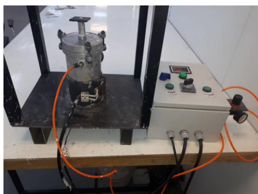
شکل ۲. دستگاه قالب‌گیری تزریقی با فشار پایین ساخت شرکت نوگرا سرام فناور
