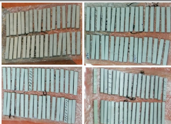
شکل ۳. چندلایه‌های الیاف - فلز ساخته شده برای انجام سیکل حرارتی
