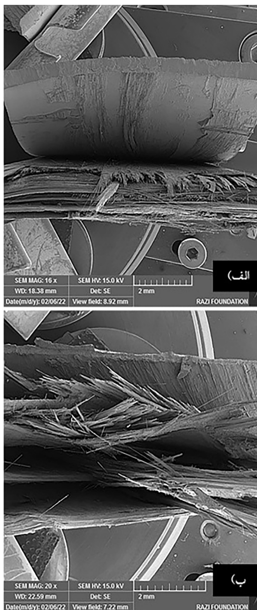
شکل ۱۳. تصویر میکروسکوپی از چندلایه الیاف - فلز پس از ۹۰ سیکل حرارتی: الف) چیدمان ۰°/۹۰°/۹۰°/۰°، ب) چیدمان ۳۰°/+۳۰°/-۳۰°/-۳۰°
