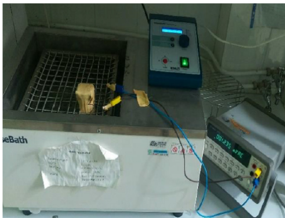
شکل ۵. سیستم به کاررفته برای تبدیل انرژی ارتعاشی به الکتریکی
