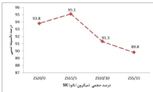
شکل ۱. مقادیر چگالی نسبی بر حسب تغییرات درصد حجمی \text{SiC} نانو و میکرون در دمای سیتتر 2150^{\circ}\text{C} درجه سانتی‌گراد.
