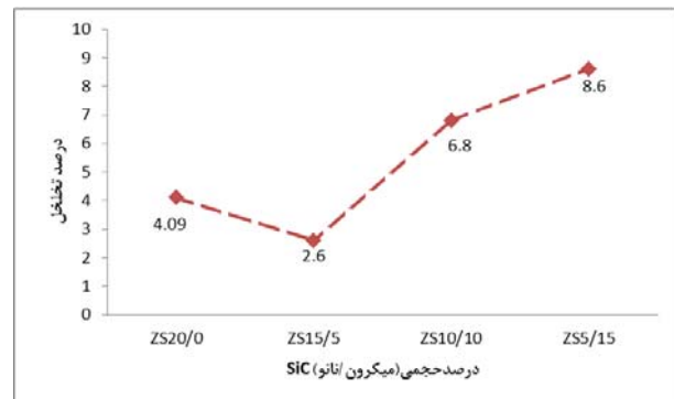
شکل ۲. مقادیر تخلخل ظاهری برحسب تغییرات درصد حجمی SiC نانو و میکرون در دمای سیتتر ۲۱۵۰ درجه سانتی‌گراد.
