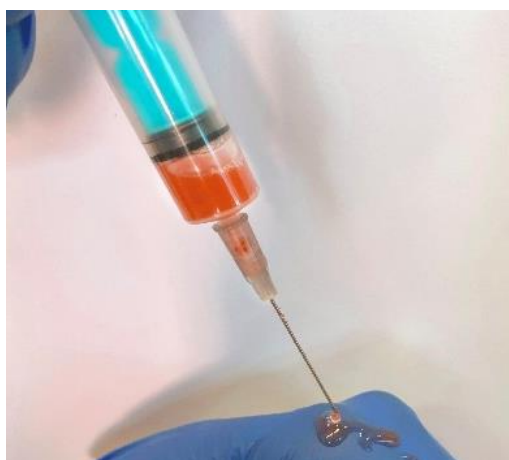
شکل ۷. سرنگ‌پذیری هیدروژل DOX/F127 با استفاده از یک سرنگ ۵ سی‌سی
