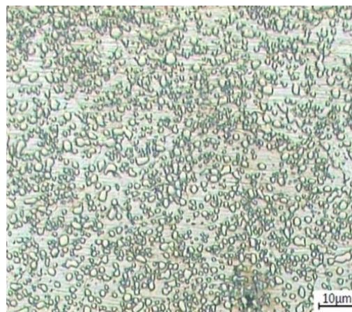
شکل ۱۴. ریزساختار اولیه فولاد، زمینه فریت با توزیع کاربرد
