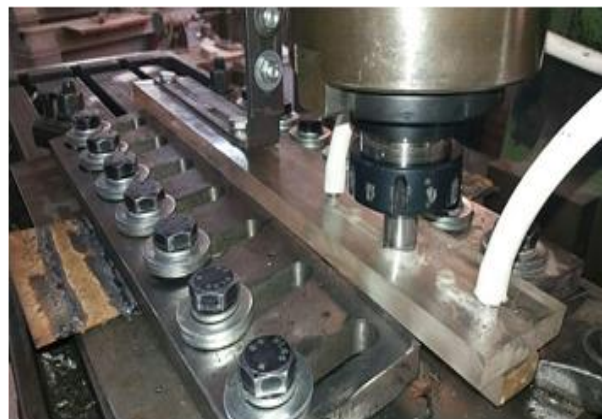
شکل ۳. نمای نزدیک قرار گرفتن محفظه‌ی گاز آرگون بر روی قطعه‌ی کار
