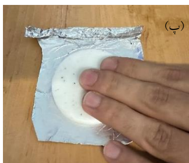
شکل ۶. (الف) تصویر شماتیک اجزای نانوژنراتور تریبوالکتریک شامل پوست دست، سیلیکون بهداشتی و الکتروود آلومینیم و تصویر، (ب) شماتیک و (پ) واقعی نانوژنراتور تریبوالکتریک مونتاژشده در حالت کاری تک‌الکتروودی
