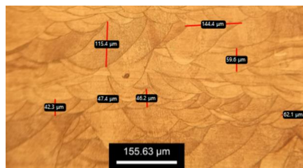
شکل ۷. تصویر میکروسکوپی نوری از نمونه D-5 در جهت عمود بر پرینت
