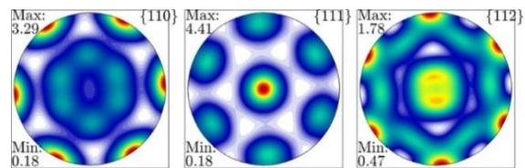
شکل ۷: تصاویر قطبی شبیه‌سازی برای یک‌سوم ضخامت در نمونه نورده شده در دمای ۳۰۰ درجه سلسیوس
