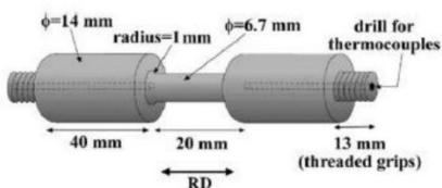
شکل ۱. تصویر طرحواره هندسه نمونه‌های پیچش گرم
