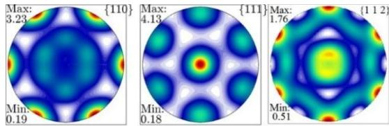
شکل ۱۰: تصاویر قطبی شبیه‌سازی برای یک‌سوم ضخامت در نمونه نورده شده در دمای ۳۰۰ درجه سلسیوس
