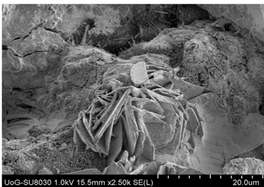
شکل ۱۰. ریزساختار بتن پس از ۶۳ روز ترمیم توسط باکتری با راندمان حدود ۴۰ درصد [۷۷]
