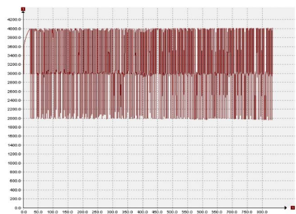
شکل ۱۱. نمودار شارژ-دشارژ در ۱۰۰۰ چرخه در حضور نانوکاتالیزور
