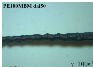
شکل ۹. تصویرهای میکروسکوپی برای نمونه PE100 در سرعت‌های برشی مختلف (در شکل سرعت‌های برشی نمایش داده شده‌اند).
