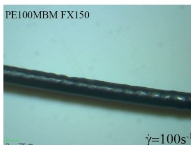
شکل ۱۱. تصویرهای میکروسکوپی برای نمونه‌ی PE100MBM در مقادیر مختلف از کمک‌فرآیند FX در سرعت برشی 100 \text{ s}^{-1} .
