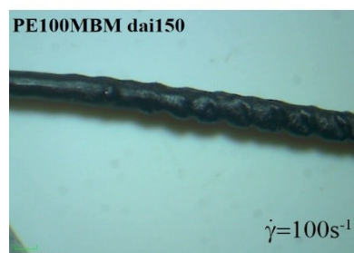
شکل ۱۰. تصویرهای میکروسکوپی برای نمونه‌ی PE100MBM در مقادیر مختلف از کمک‌فرآیند daikin در سرعت برشی 100 \text{ s}^{-1} .
