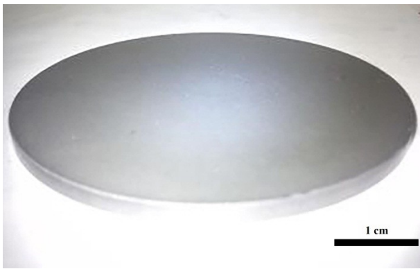
شکل ۵. نمای ظاهری تارگت کندوپاش BST سینتر شده در دمای 1250^{\circ}\text{C} به مدت دو ساعت.
