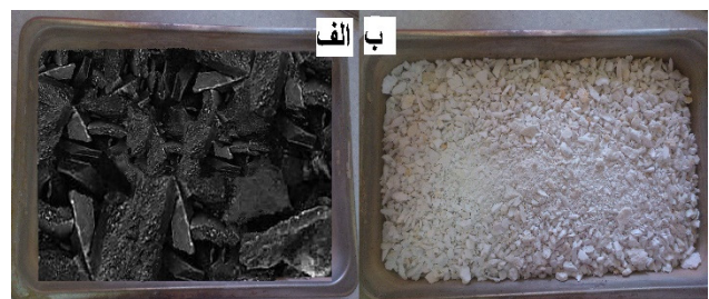
شکل ۱. مراحل تهیه پودر هیدروکسی آپاتیت: (الف) دمای 400^\circ\text{C} (ب) دمای 900^\circ\text{C}
