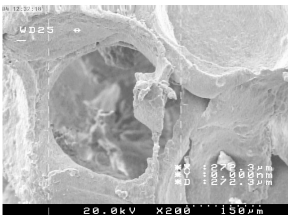
شکل ۱۰. تصویر SEM داربست متخلخل HA/TiO_2 با بزرگنمایی ۲۰۰ برابر
