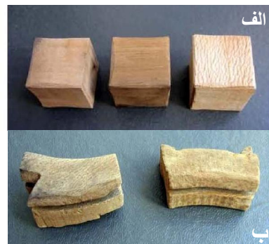
شکل ۲. الف) نمونه چوب های جدید، از راست به چپ: چنار، گردو و گلابی، ب) نمونه چوب های تاریخی از راست به چپ: چنار مربوط به دوره صفوی، چنار مربوط به دوره قاجار
