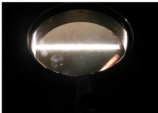
شکل ۳. یک میله گرافیت نوع دوم هنگام عبور جریان.
